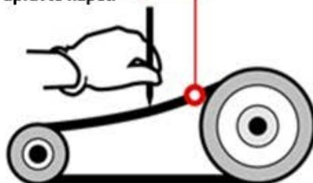
Upravte napětí, zabráníte tak sklouznutí řemene a nechte běžet 5 minut a znovu napněte. Popřípadě opět upravte napětí po několika dnech provozu.
