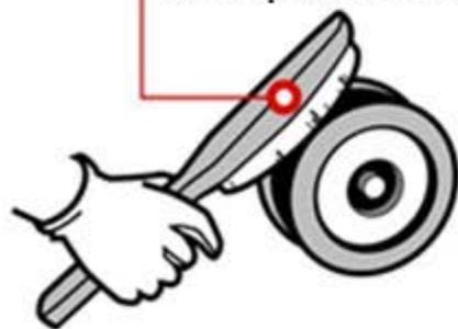
Zkontrolujte povrch řemenice a odstraňte veškerou rez, nečistoty nebo mastnotu. Mohou ovlivnit používání řemene.
