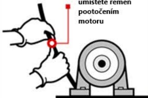
Umístěte řemen pootočením motoru.
