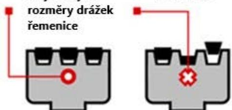
Zkontrolujte drážky řemenice a ujistěte se, že mají stejné rozměry.
